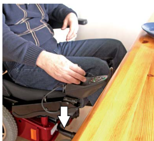
Le panneau de commande se rabat sans palier jusqu'à la position voulue – un avantage quand on est assis à table.
